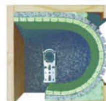
TECNO THERM FLEX inserito dal lato interno del cassonetto.
